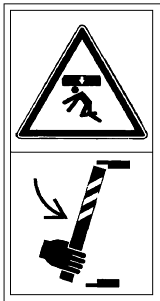
图 1 车厢升降过程中,不得进入危险区。 进入车厢下进行保养或维修前, 必须支起保险杆
