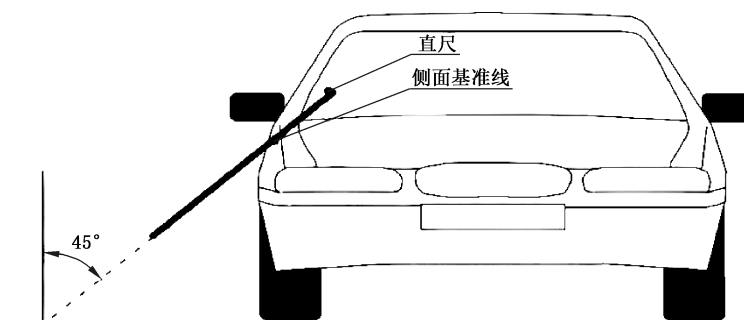
图3 侧面基准线示意图
