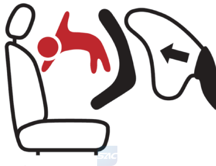
c) 安全气囊展开对座椅安装后向儿童约束系统造成危险的警告象形图
